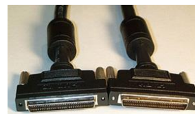
SCSI-buss sammenkobling av harddisker
